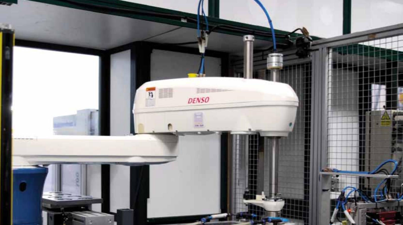
**Con il robot SCARA di Denso fornito da K.L.A.IN.robotics, Rayair ha aiutato un'azienda cliente ad aumentare la velocità di pick-and-place dei pezzi del 40% e a ridurre i tempi di cambio lavoro del 60%.**
