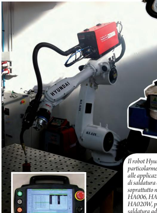
*Il robot Hyundai è particolarmente adatto alle applicazioni di saldatura e, soprattutto nei modelli HA006, HA010LW, HA020W, per saldatura ad arco.*
