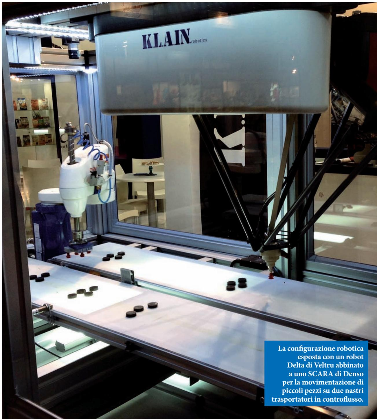
La configurazione robotica esposta con un robot Delta di Veltru abbinato a uno SCARA di Denso per la movimentazione di piccoli pezzi su due nastri trasportatori in controflusso.
