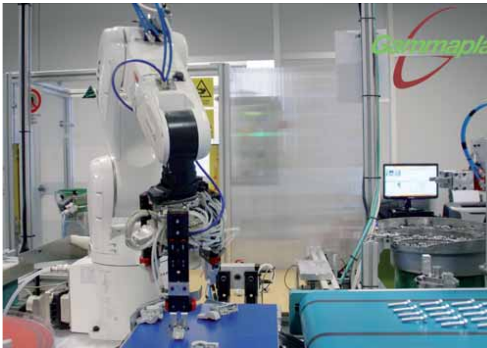
Alcuni robot sono dotati di un sistema di visione con relativo software per la gestione automatizzata.
