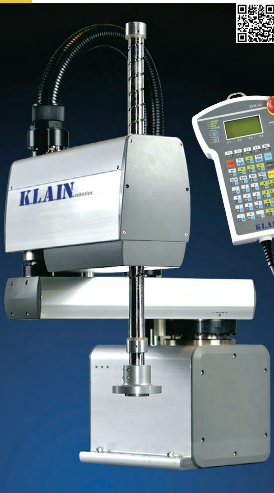
Robot dASAROBOT da 600 mm di raggio.
