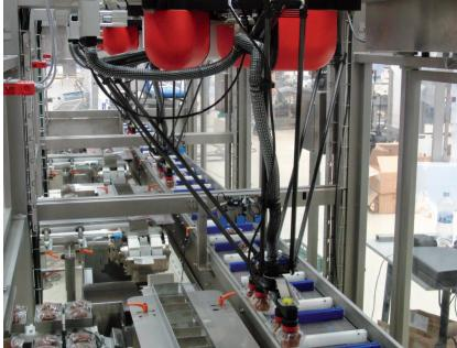
nonostante l'elevato dinamismo e numero di cicli, un solo robot non è sufficiente e il lavoro viene dunque suddiviso tra più macchine. In entrambi i casi, la capacità e l'efficienza di comunicazione tra i vari robot è di fondamentale importanza.
